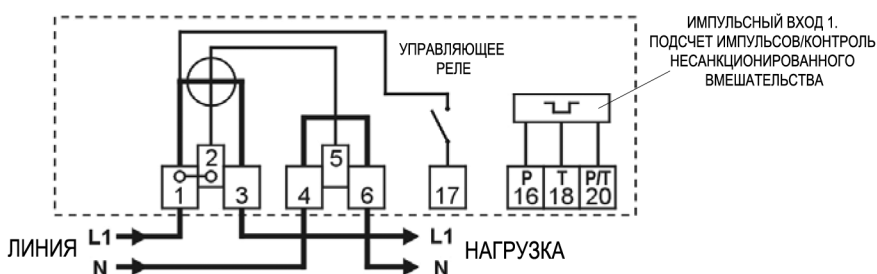
Рисунок 2.4. Однофазный счетчик, схема подключения без устройства управления отключением нагрузки
