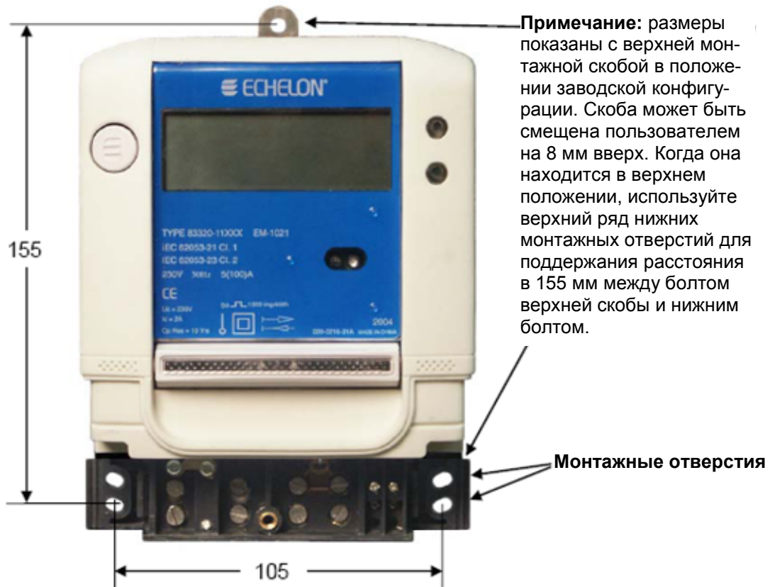
Рисунок 2.1. Расположение монтажных отверстий и размеры (мм) для однофазных счетчиков KNUM-1021
