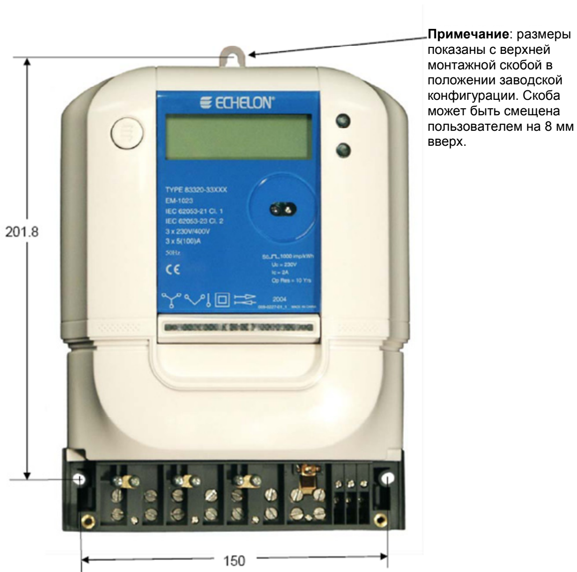
Рисунок 2.2. Расположение монтажных отверстий и размеры (мм) для многофазных счетчиков KNUM-1023 и KNUM-2023
